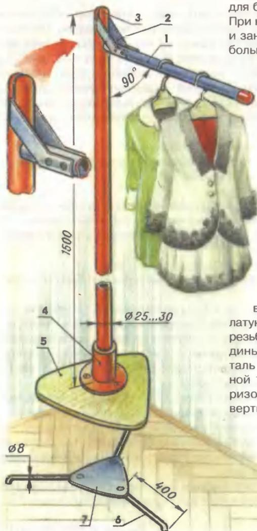
вставляют в стальной подпятник, выточенный на токарном станке и с помощью шурупов прикрепленный к основанию в форме треугольника со скругленными углами из древесно-стружечной плиты или толстой доски из плотной древесины.
